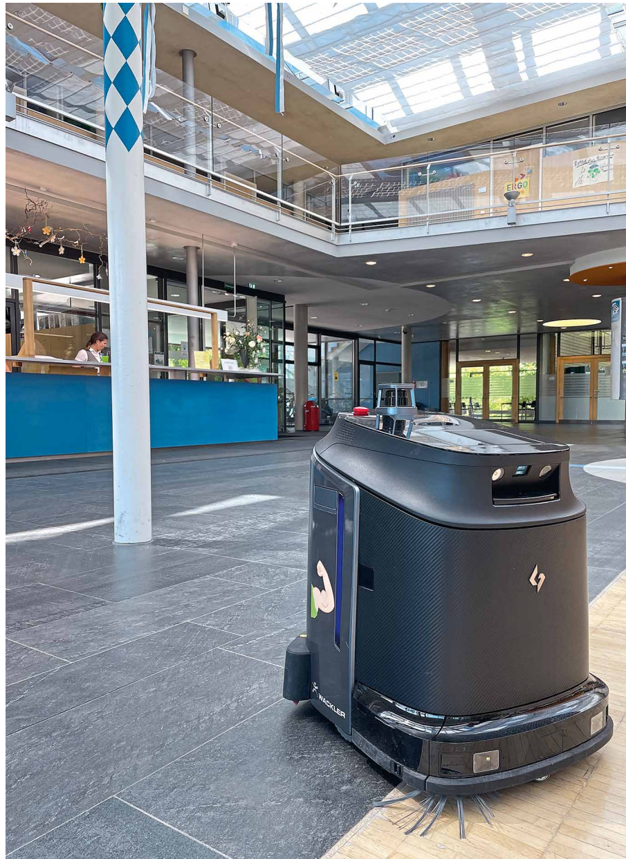
Der von Wackler in einer Kinderklinik getestete Roboter verfügt über vier Anwendungsmodi: Staubsaugen, Kehren, Schrubben und Staubwischen.
